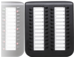
Optionale Erweiterungskonsole mit 48 Tasten (KX-DT546/KX-DT543)
